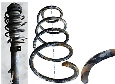
Rajah 2.1 Contoh kegagalan pada pegas heliks
