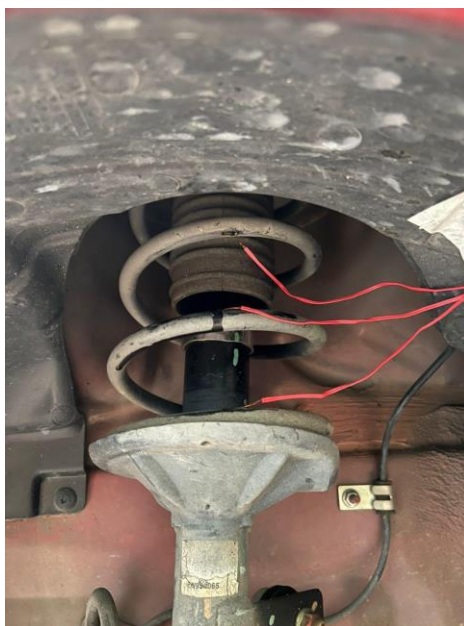
Rajah 3.7 Tolok terikan pada pegas gelung
