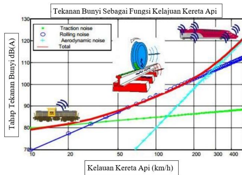
Rajah 2.3 Sumber bunyi luar kereta api dan pergantungan biasa terhadap kelajuan kereta api (Komuniti Eropah, 2003).
